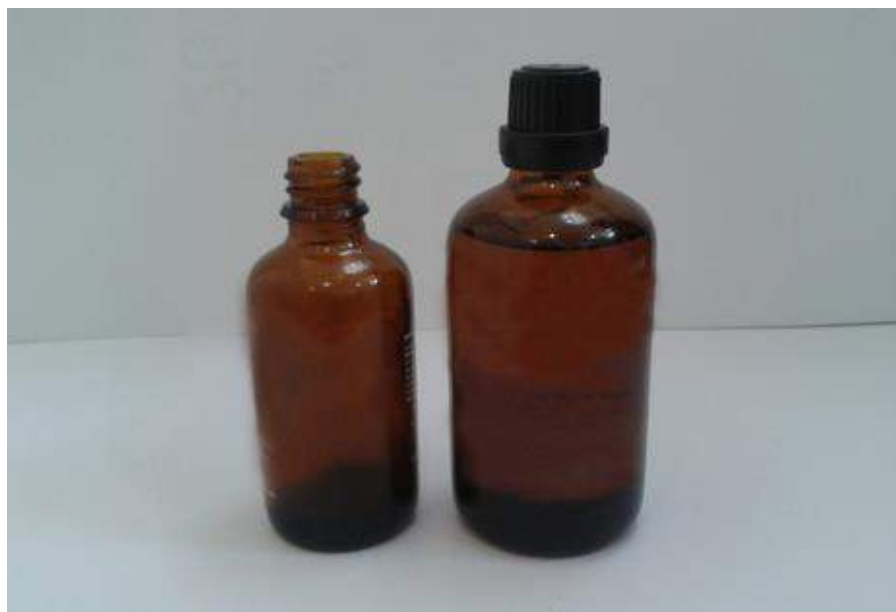
Foto 1 - Modelo de frasco de borosilicato com capacidade de 100ml e tampa rosqueável, para amostragem de óleo (análise de BETEX).
