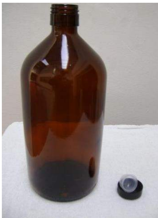
Foto 2 - Modelo de frasco de borosilicato, cor âmbar, com capacidade de 1L para amostragem de óleo (análise de PAH/Benzeno)
